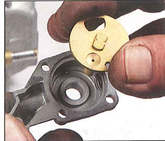
Je nach Stellung dieser Scheibe gibt die Starteinrichtung mehr oder weniger Sprit ins Saugrohr ab
