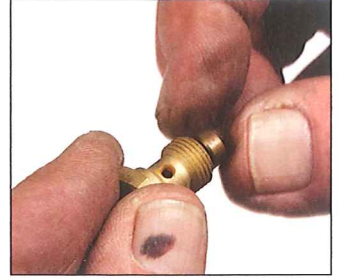
Die kleine Hauptdüse wird in den größeren Düsenträger eingesetzt. Sie begrenzt den Spritzfluss
