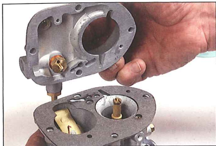
Alle Durchgangsbohrungen bleiben frei: Diese Dichtung ist für unseren 40 BI die Richtige. Deckel drauf und die Montage ist beendet
