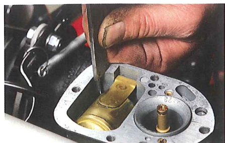
Der richtige Pegelstand in der Schwimmerkammer ist Voraussetzung für alle weiteren Einstellungen. Er wird von der Gehäusekante aus gemessen
