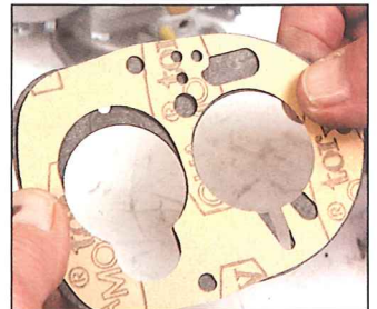
Mit dem Original verglichen: Für sehr ähnliche Vergaser gibt es sehr unterschiedliche Dichtungen!
