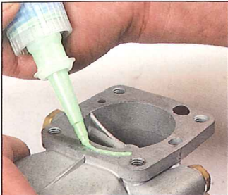
Zwischen Drosselklappenstutzen und Vergasergehäuse ist keine Dichtung vorgesehen. Bob...
