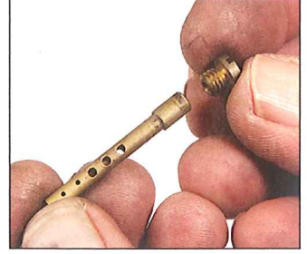
Das gelochte Mischrohr und die Luftkorrekturdüse sind speziell auf einen Motortyp abgestimmt
