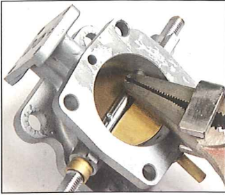
Die Halteschrauben der Klappe werden mit Loctite eingesetzt und zusätzlich am Gewinde verformt
