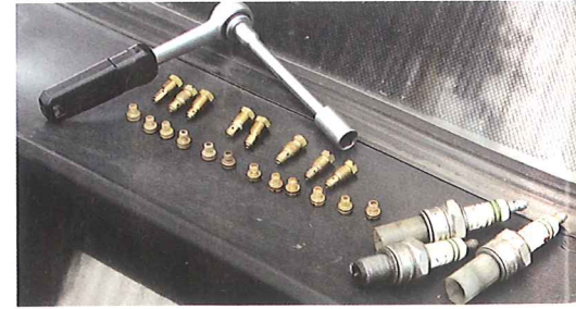
Probieren geht über Studieren: Anhand des Kerzenbildes nähert man sich Schritt für Schritt an die richtige Düsenbestückung an
