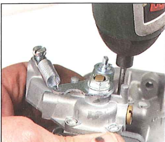
Viele Schrauben an Solex-Vergasern haben exotische Gewinde. Das sicherte einst das Ersatzteilgeschäft
