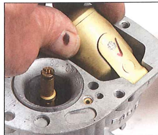
Vor dem Einbau hat Bob den überholten Originalschwimmer auf Dichtheit geprüft
