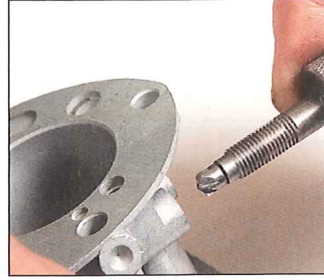
Mit speziellen Fräsern bearbeitet Bob die Sitze der Düsen, bis alte Riefen beseitigt sind
