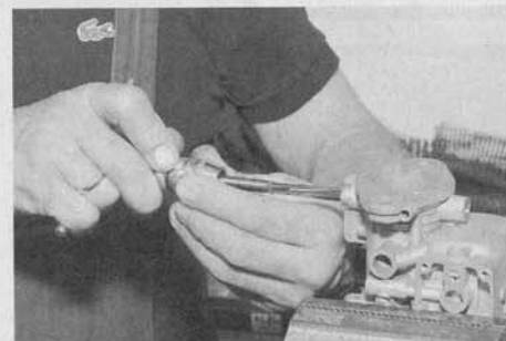
...das praktisch immer vorhandene Spiel. Eine Reibahle bringt die Buchsen aufs richtige Maß
