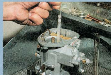
Und noch ein Fall für den Spezialisten: Ein Test zeigt, ob die Beschleunigerpumpe korrekt arbeitet
