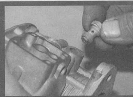
Es geht an den Wiederausbau: Hauptdüse und Leerlaufdüse können eingeschraubt werden
