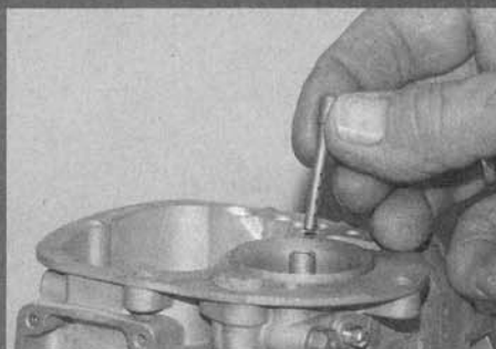
Das Mischrohr selbst ist in den Träger einfach nur eingesteckt, anschließend sichert ihn dann die...
