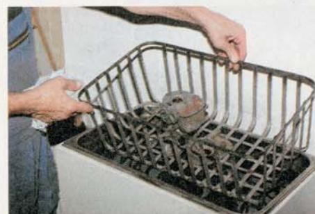
Erste Reinigung: Im Ultraschallbad wird der noch nicht weiter zerlegte Vergaser grob gesäubert
