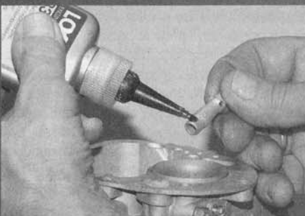
Vorher entfetten: Der Mischrohrträger wird mit Schraubensicherungsmittel eingeklebt
