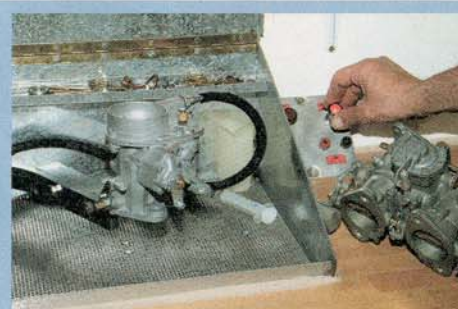
Unter Profibedingungen: Auf dem Prüfstand wird getestet, ob das Nadelventil dicht hält
