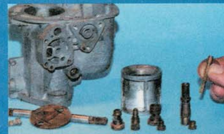
Das Zerlegen: Aus dem Schwimmerkammerdeckel werden das Nadelventil und die Belüftung entfernt (o. l.). Die Schrauben der Drosselklappen sitzen sehr fest und müssen manchmal ausgebohrt werden (o. M.). Das in den Fingern gehaltene Mischrohr fehlte in unserem Fall völlig (o. r.). Auch der Chokemechanismus wird komplett zerlegt, die Feder drückt die Scheibe gegen eine Lauffläche am Gehäuse (u. l.). Selbst relativ einfache Vergaser bestehen aus etlichen Einzelteilen (u. r.).
