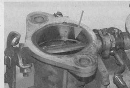
...arbeitet sich die Klappe wie hier gezeigt ins Gehäuse ein – ein teures Vergnügen!
