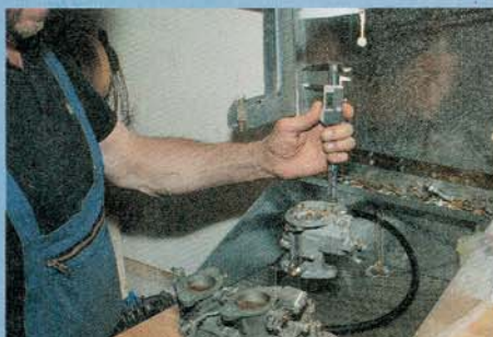
Stimmt der Benzinpegel? Auch das prüft der Fachmann abschließend
