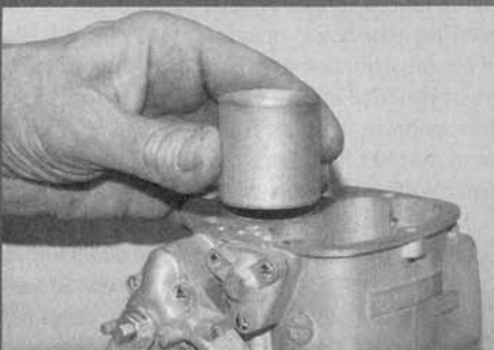
Der sensible Lufttrichter wird einfach in das Vergasergehäuse eingesetzt und mit einer...
