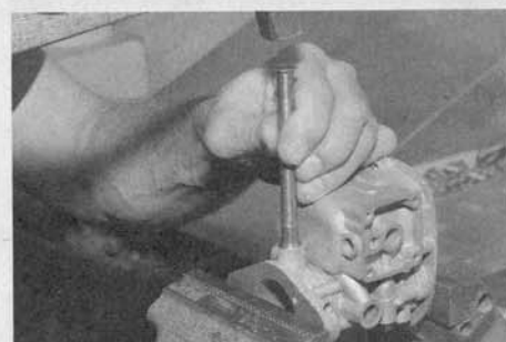
Ab Werk läuft die Drosselklappenwelle direkt im Gehäuse. Lagerbuchsen aus Messing kurieren...
