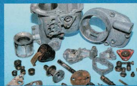
Das Zerlegen: Aus dem Schwimmerkammerdeckel werden das Nadelventil und die Belüftung entfernt (o. l.). Die Schrauben der Drosselklappen sitzen sehr fest und müssen manchmal ausgebohrt werden (o. M.). Das in den Fingern gehaltene Mischrohr fehlte in unserem Fall völlig (o. r.). Auch der Chokemechanismus wird komplett zerlegt, die Feder drückt die Scheibe gegen eine Lauffläche am Gehäuse (u. l.). Selbst relativ einfache Vergaser bestehen aus etlichen Einzelteilen (u. r.).
